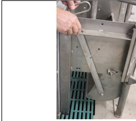
Figur 12. Soens fodertrug kunne vippes og tømmes foran og udenfor opsamlingsbakken.
